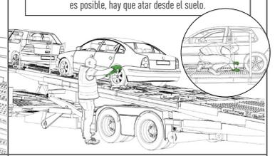
D. Coches situados en la plataforma superior del remolque y todos los situados en la plataforma inferior: atarlos desde el suelo
