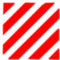
Негабаритный груз — сигнальные щитки или флагги размером 400x400 мм с нанесенными по диагонали чередующимся красными и белыми полосами (ширина — 50 мм), а в темное время суток и в условиях недостаточной видимости — световозвращателями или фонарями: спереди белого цвета, сзади — красного, сбоку — оранжевого. Знак размещается на крайних внешних частях груза, который выступает за габариты транспортного средства на расстояние, большее чем это предусмотрено пунктом 22.4 настоящих Правил.
