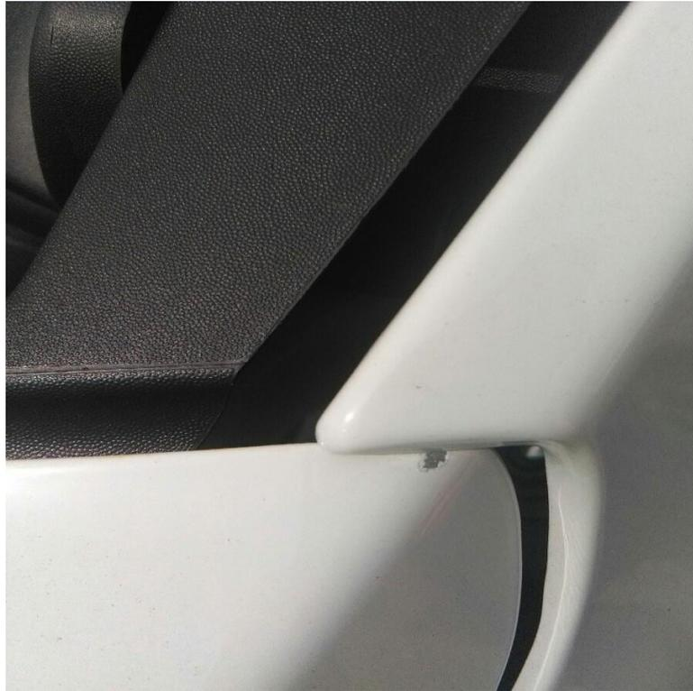
9. Verbogene Teile aufgrund von Ausrichtungsfehlern
