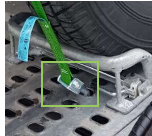
Beispiel: Anschlagpunkt auf dem Fahrbahnblech
