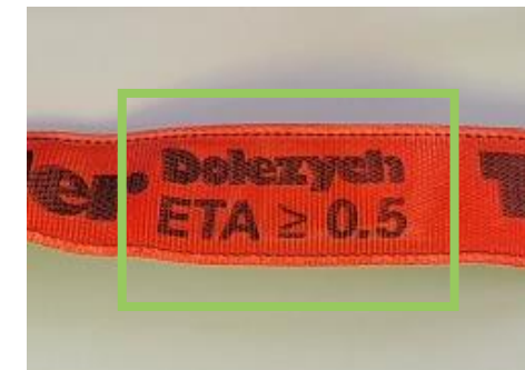
Dolezych strap with ETA value on the controller
