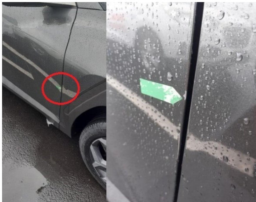
12. Daños en juntas de carrocería o bordes de paneles no accesibles durante el transporte.
