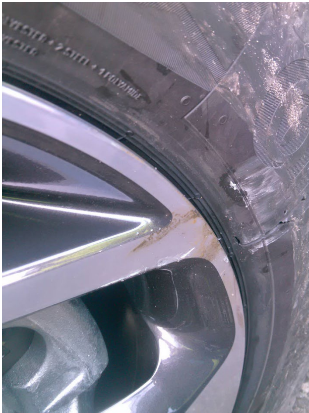
7. Daño en llantas: arañazo en la llanta exterior (no en el interior ni cerca de las tuercas).
