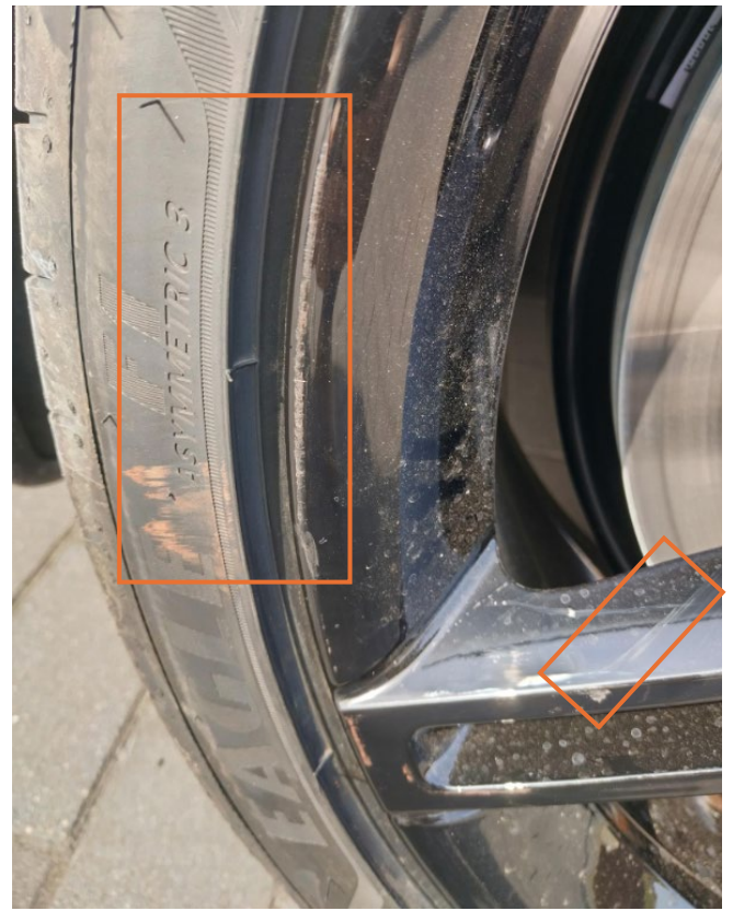
7. Daño en llantas: arañazo en la llanta exterior (no en el interior ni cerca de las tuercas).
